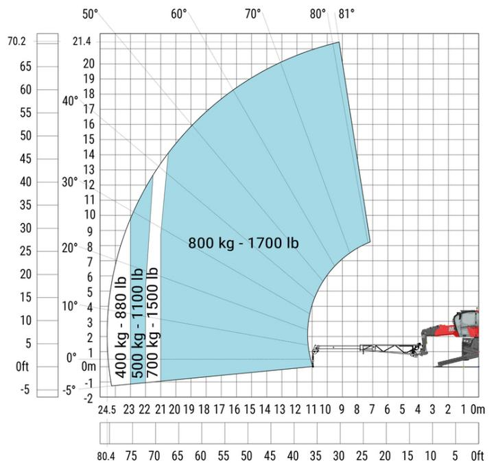
Машина на опущенных аутригерах с крюком 6000кг, метрическая система мер
