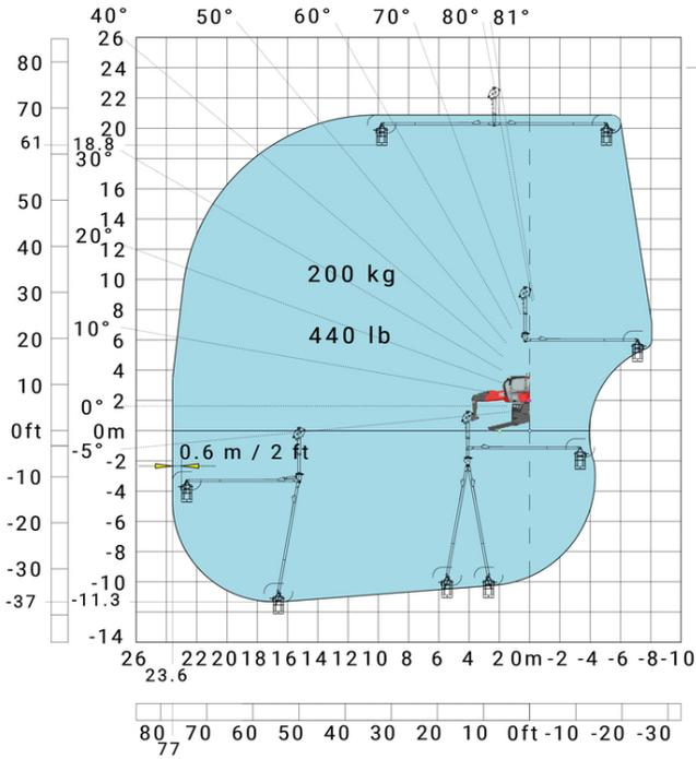
Машина на опущенных аутригерах с выдвинутой кран-балкой с лебедкой, метрическая система мер
