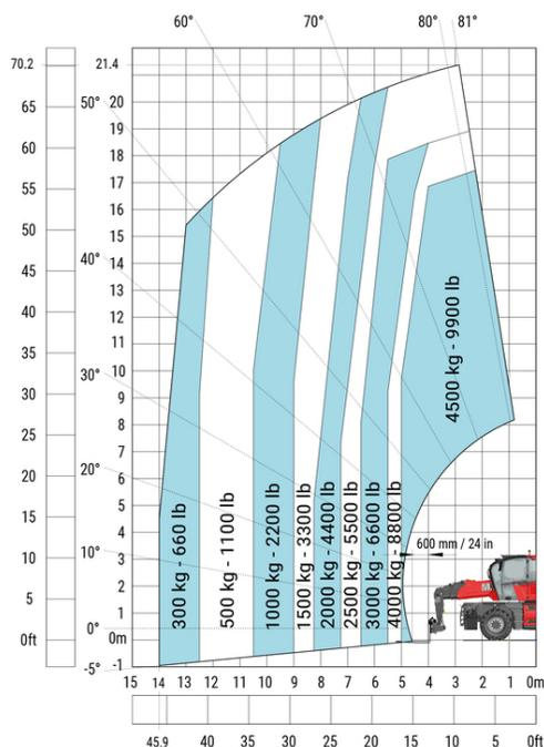
Машина при опущенных аутригерах с вилами - метрическая система мер
